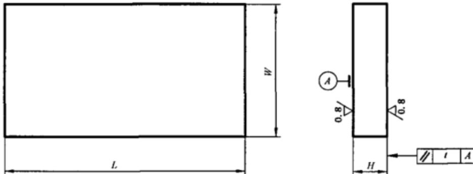
未注表面粗糙度  $R_a=6.3 \mu\text{m}$ ;全部棱边倒角  $2 \text{ mm} \times 45^\circ$ 。
